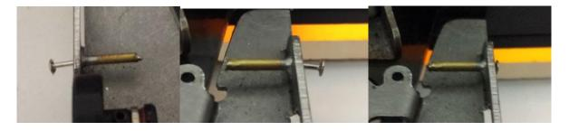
La lunghezza massima dei tubetti è di 9 mm e tutti devono essere lunghi uguali, non sono ammessi eccessivi apporti di stagno oltre a quello necessario per la saldatura come foto da esempio.
